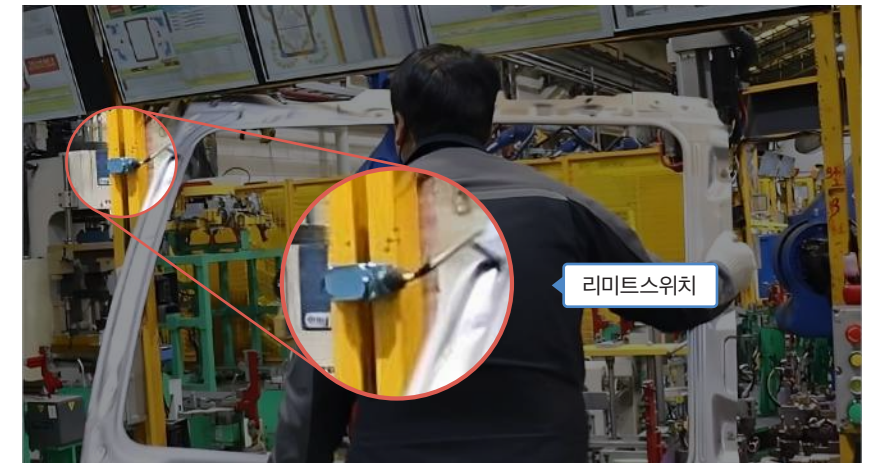
공무팀 과장이 사고 1년 전 만들었다는 리미트 스위치 버튼. 들고 있던 프레임으로 하늘색 스틱을 치면 로봇이 다음 작업을 이어 나가게 된다. 작업자로서는 시작 버튼을 손으로 누르는 수고로움이 줄어드는 셈이었다
