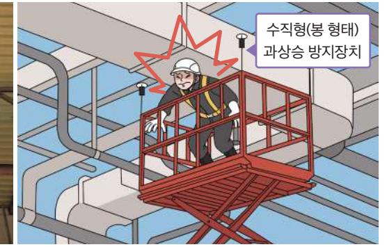
고소작업대 끼임 사고 모습
