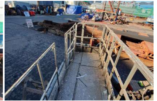
사고가 발생한 고소작업대 출입문. 자동으로 닫히지 않는 구조였다
