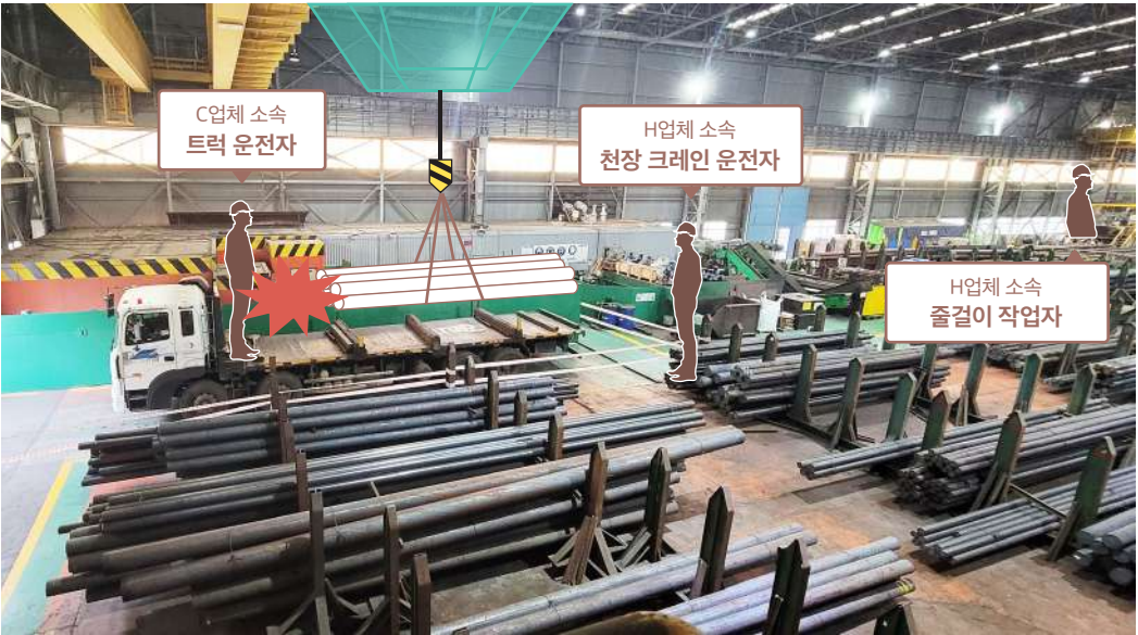
박재호 씨는 트럭 적재함 위에 있었고, 천장 크레인 운전자는 트럭 후방에서 천장 크레인을 무선 컨트롤러를 조작하여 환봉을 운반하고 있었다
